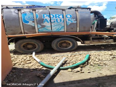
Camión cisterna Porto Aguas EP realizando el achique de aguas residuales
